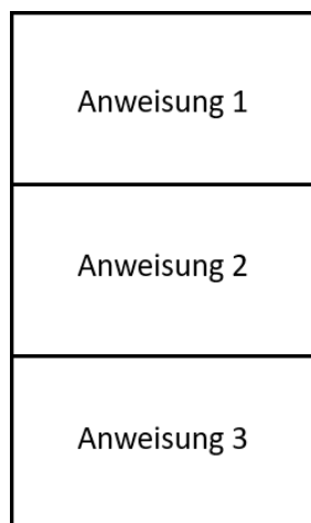
Abbildung A.08: Beispiel für ein Struktogramm (hier: Sequenz) gemäß DIN 66261 bzw. EN 28631.
